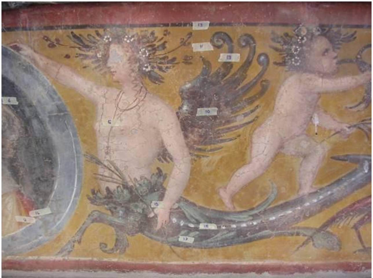
Fig. 3. Monitoraggio dell'applicazione di ossalato di ammonio sulla fascia policroma. Ubicazione di alcuni punti di misura
